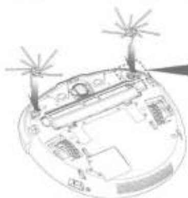
Гнездо и вал боковой щетки
